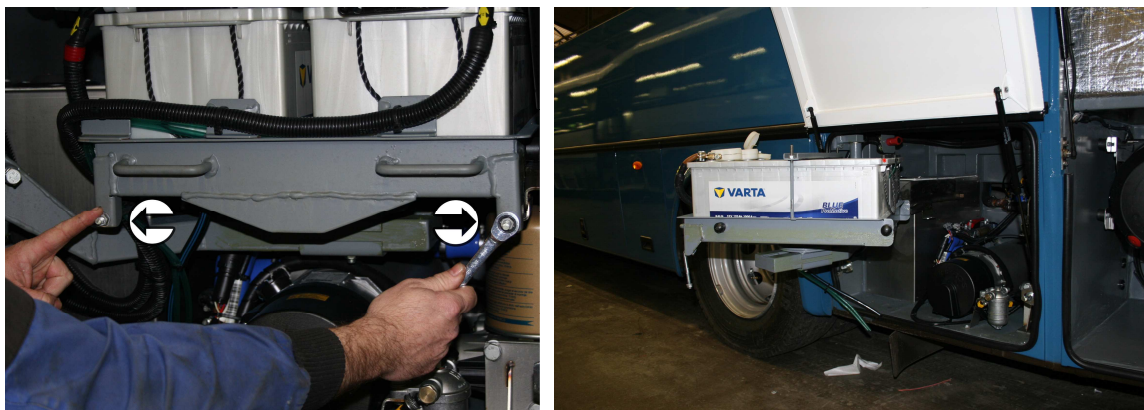
Obrázek 76: Vysouvání akumulátorů z předposlední schránky vpravo. Před vysouváním je třeba uvolnit dva zajišťovací háčky (šipky). Po vysunutí saní je možno je vytočit – obrázek vpravo
