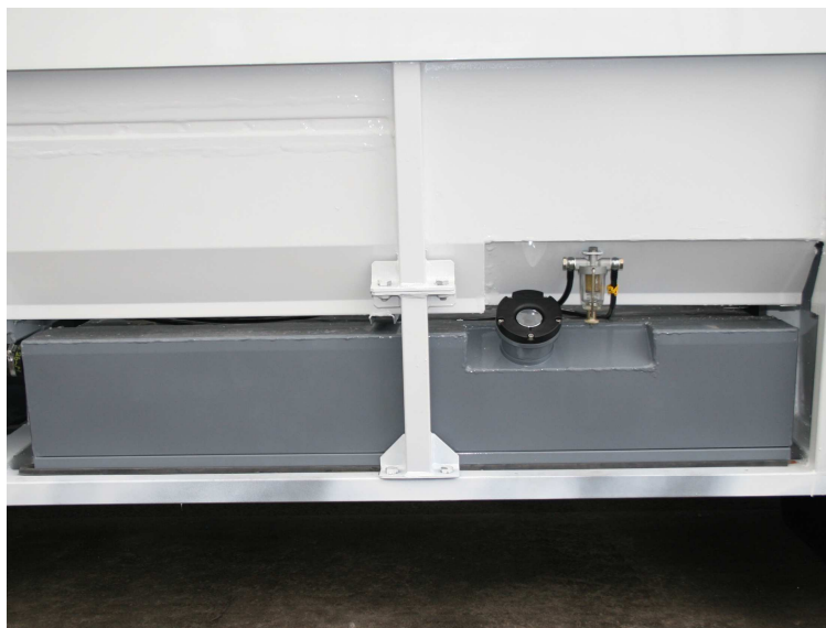
Obrázek 53: Nádrž nízkopodlažního vozu
