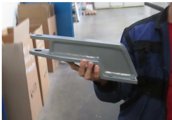
Obrázek 15: Přední vyprošťovací zařízení staršího provedení. Na snímku vlevo je přední levý konec roštu podvozku, kam se zařízení montuje; vpravo oko zařízení
