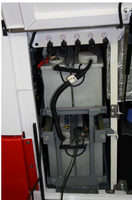
Obrázek 74: Akumulátory v poslední schráně vpravo (nízkopodlažní vůz). Pro jejich vysunutí je třeba odebrat šrouby označené šipkami. Šrouby, označené kroužkem, drží akumulátory v držáku
