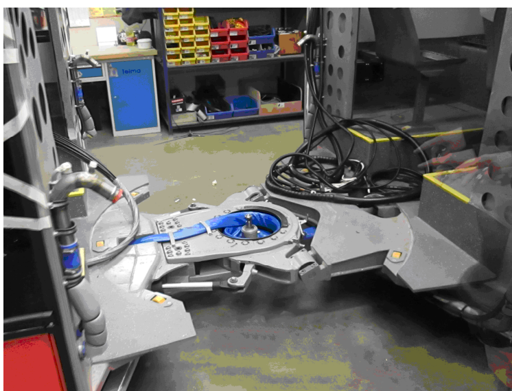
Obrázek 43: Kloub ve spoji kloubového autobusu
