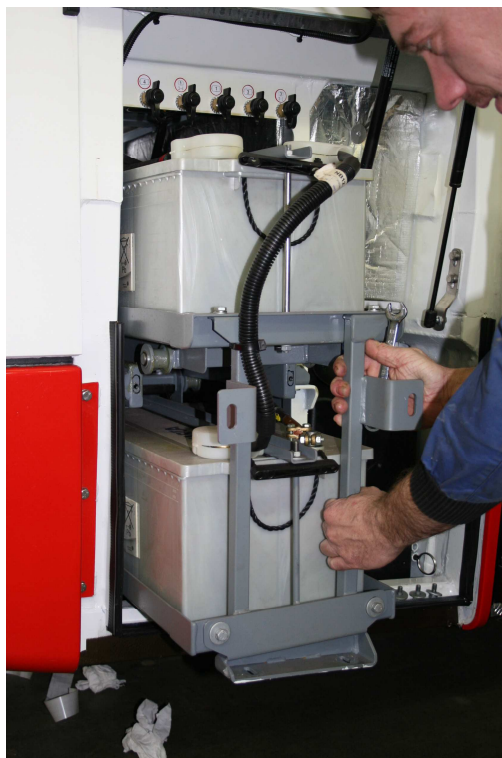
Obrázek 75: Vysouvání držáku s akumulátory u nízkopodlažního vozu
