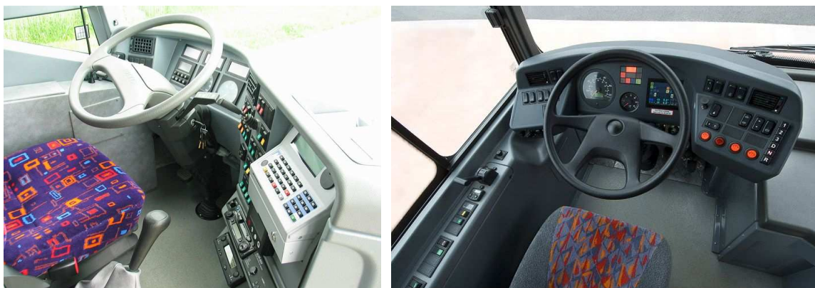
Obrázek 46: Pracoviště řidiče. Vlevo vozidlo s mechanicky řazenou převodovkou; vpravo s automatickou převodovkou
