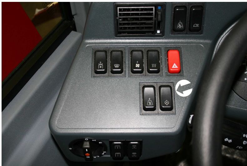
Obrázek 48: Ovladač vzduchotlakového blokování přestavování volantu. Vlevo standardní symbol na spínači; vpravo spínač
