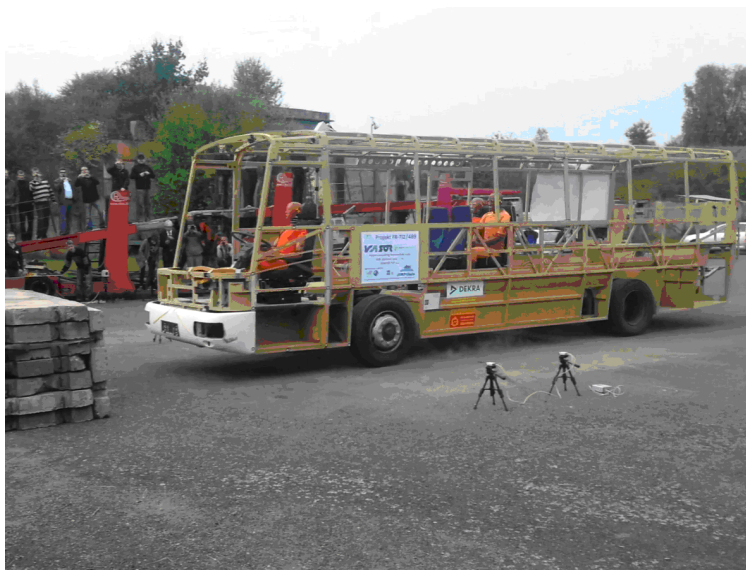
Obrázek 12: Bariérová zkouška – okamžik nárazu vozu do bariéry rychlostí kolem 25 km/h
