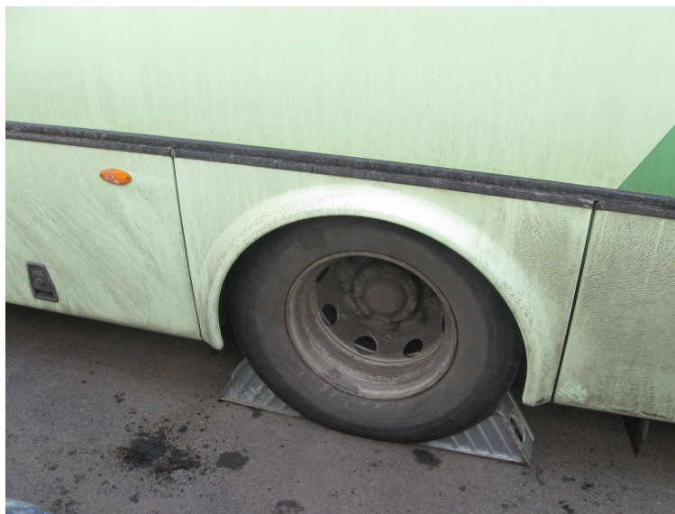
Obrázek 81: Zajištění autobusu proti pohybu oboustranným podložením klínů
