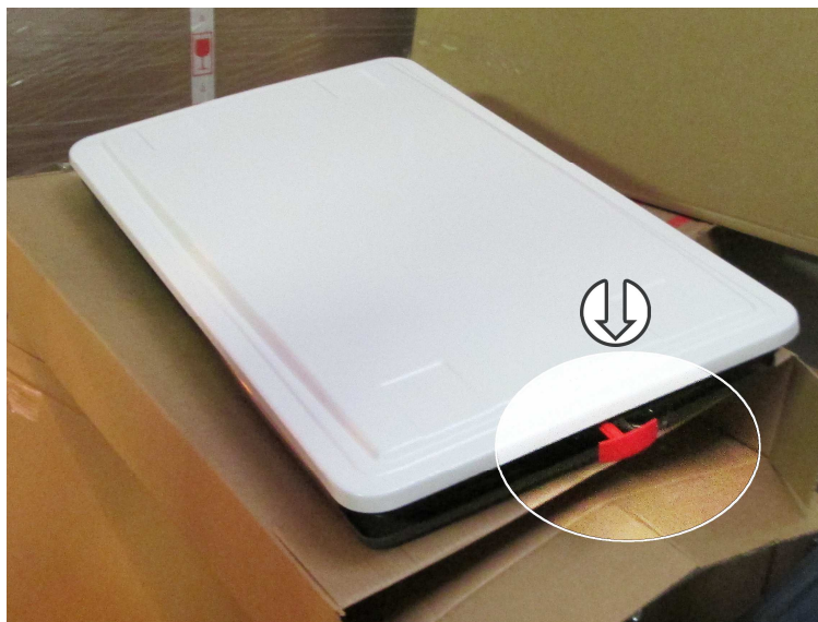
Obrázek 36: Kryt střešního nouzového východu novějšího provedení – před montáží na vozidlo. Zvenčí vozu jej lze otevřít po zatažení za červené ovládací táhlo
