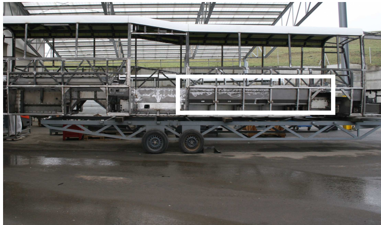
Obrázek 21: Zesílení bočnice nízkopodlažního vozu
