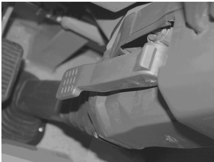
Obrázek 47: Ovládací páka blokování přestavování volantu na levé straně jeho sloupku
