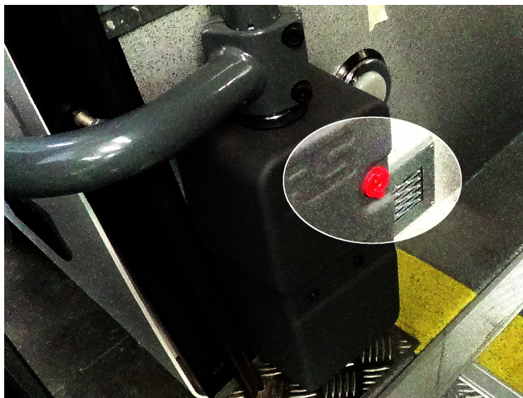
Obrázek 30: Mechanismus tlakovzdušného otevírání dveří
