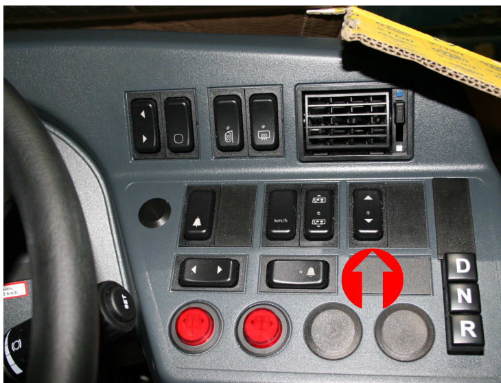
Obrázek 61: Ovladač naklonění vozu
