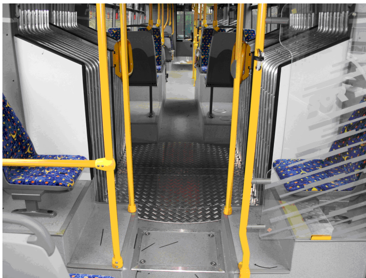
Obrázek 38: Vnitřek kloubového autobusu v prostoru kloubu. Na snímku je vidět jednak vnitřní kryt a dále pak kruhový kryt nad kloubem
