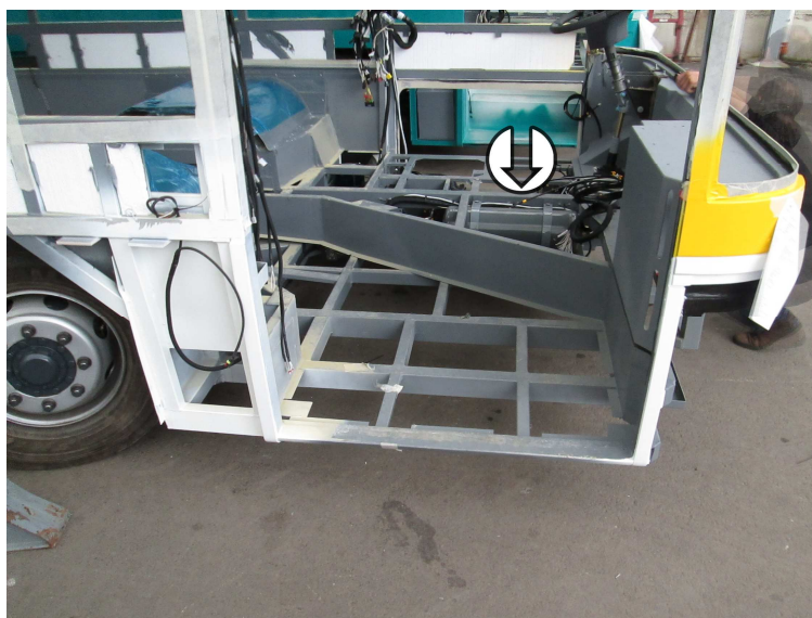
Obrázek 10: Vzduchojem uložený v roštu podvozku
