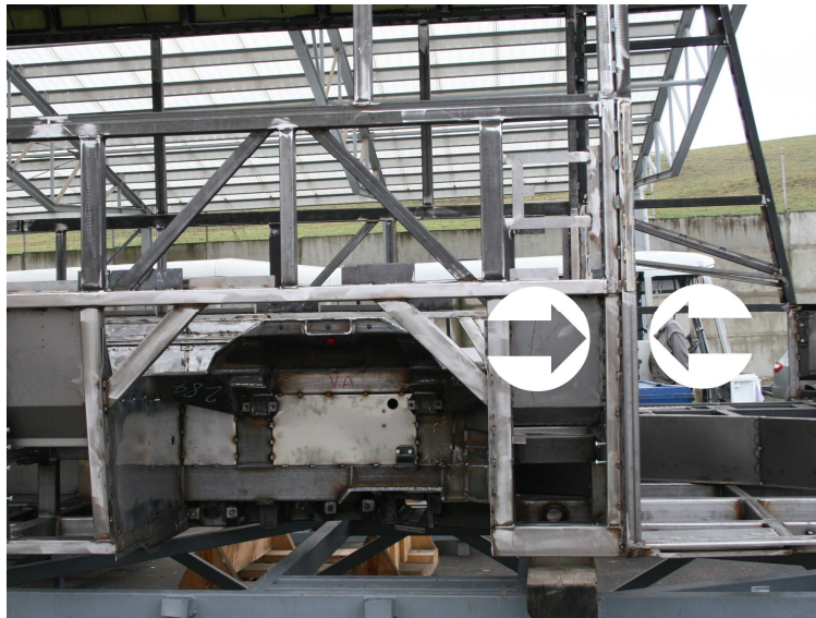
Obrázek 19: Detail místa napojení předního dílu na bočnici
