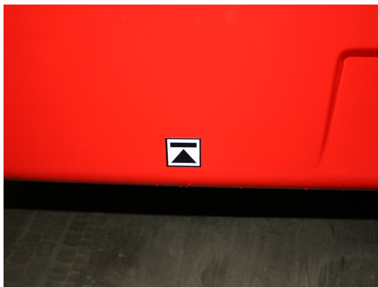
Obrázek 62: Symbol místa, určeného pro podepření vozu
