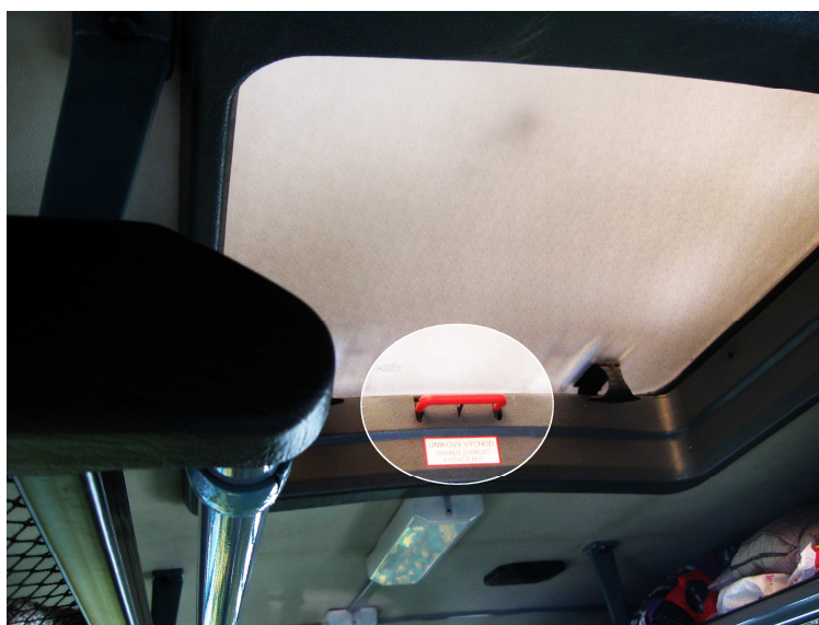
Obrázek 35: Střešní nouzový východ staršího provedení. Lze jej otevřít pouze zevnitř vozu zatažením za červenou páku
