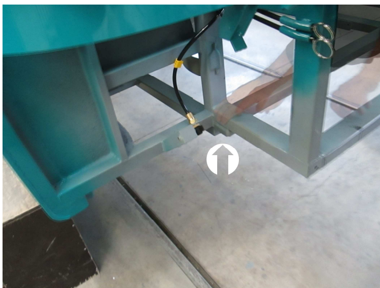
Obrázek 64: Opěrná deska pro zvedák, která má probrání pro stabilizaci horní části zvedáku. Opěra je na podélníku roštu podvozku na úrovni symbolu, který je na vnějším potahu boku vozu
