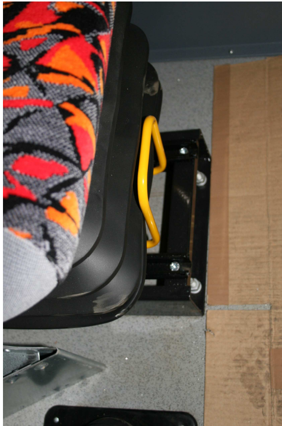
Obrázek 68: Rukojeť, která uvolňuje podélný posun sedadla
