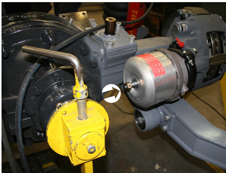
Obrázek 67: Detail brzdového válce (na nápravě před její montáží do vozu) s vytočeným šroubem nouzového odbrzdění
