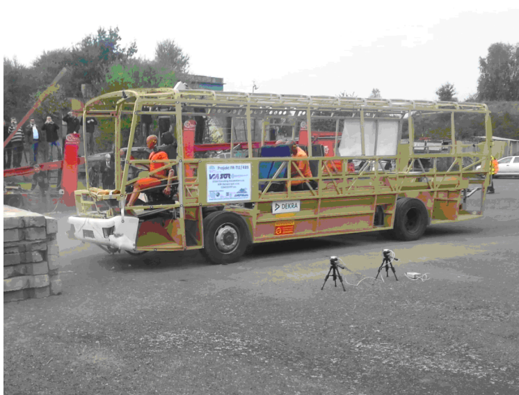
Obrázek 13: Vozidlo v konečné poloze po zkoušce (po odražení od bariéry)
