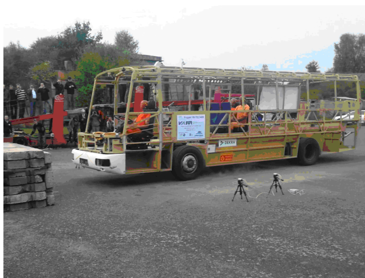
Obrázek 11: Kostra autobusu (snímek z bariérové zkoušky autobusu)
