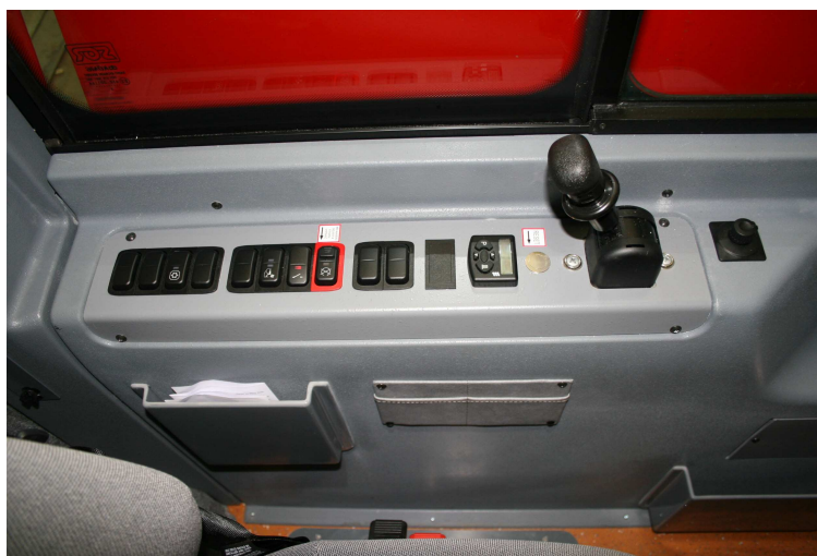
Obrázek 65: Levý pult pracoviště řidiče s ovládací pákou zajišťovací brzdy. Vůz je zabrzděný při zadní poloze ovládací páky (jako je na obrázku). Odbrzděn je při přední poloze. Na panelu jsou i spínače odpojovačů akumulátorů
