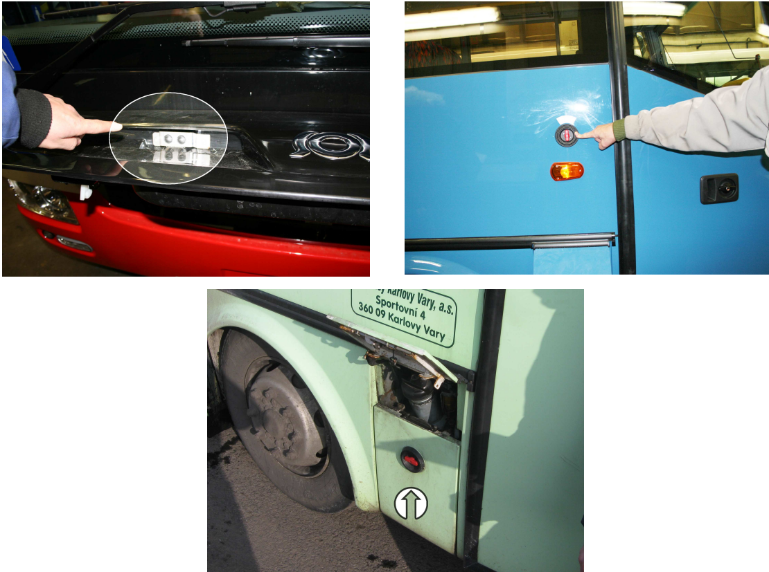
Obrázek 29: Ovladače nouzového otevírání dveří různého provedení autobusů
