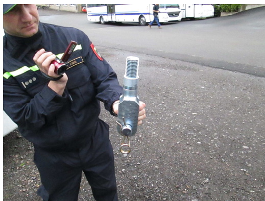
Obrázek 16: Přední vyprošťovací zařízení novějšího provedení. Na snímku vlevo je přední levý konec roštu podvozku, kam se zařízení montuje; vpravo oko zařízení
