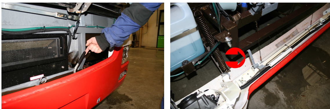
Obrázek 25: Otevírání předního víka pákou v jeho blízkosti. Vpravo zajišťovací háček
