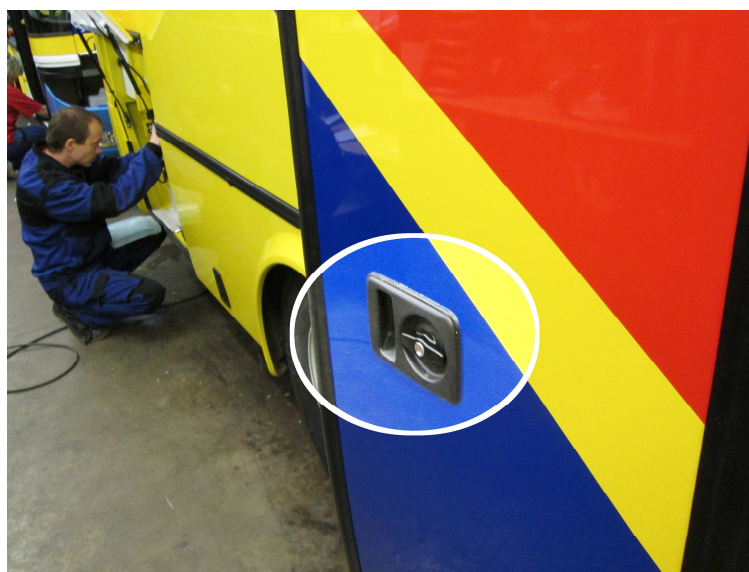
Obrázek 31: Mechanický zámek předních dveří
