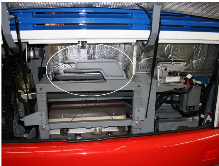
Obrázek 17: Vyprošťovací zařízení na zadní části roštu podvozku
