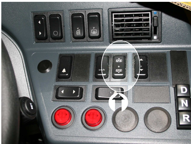
Obrázek 59: Označení spínače výšky pérování
