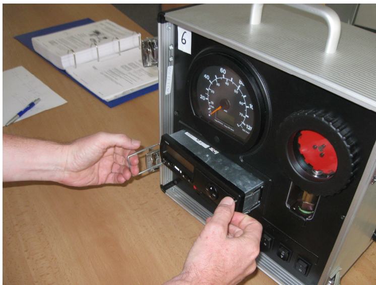
Obrázek 85: Vyjímání digitálního tachografu ze zkušební stolice v servisu
