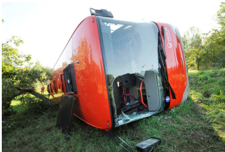
Obrázek 34: Příklad vyříznutého čelního skla autobusu. Otvor byl vyříznut přímočarou akumulátorovou pilou
