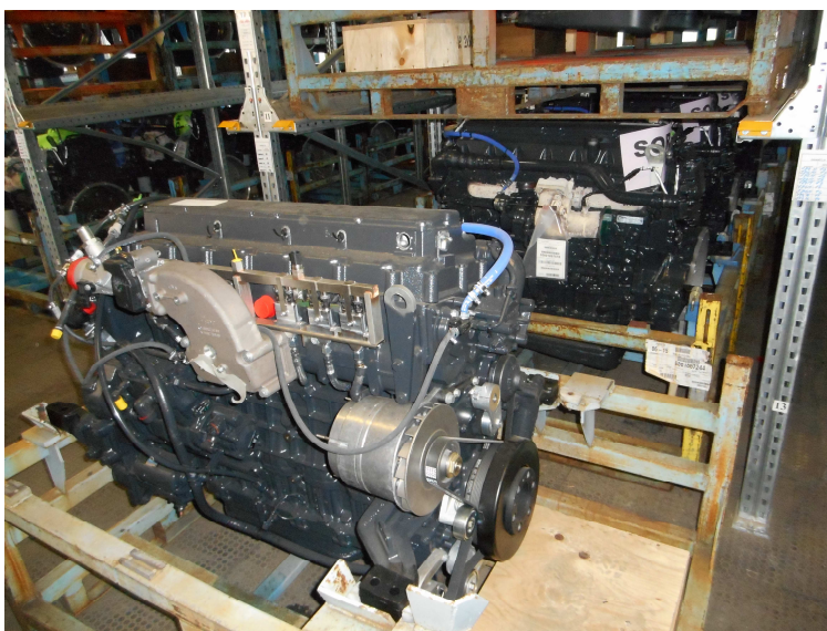
Obrázek 8: Motor určený pro spalování CNG před montáží do vozu
