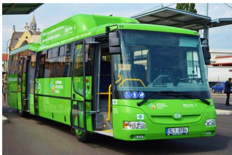
Obrázek 4: CNG 12.3. Délka 12,29 m, obsaditelnost 78 až 80 osob
