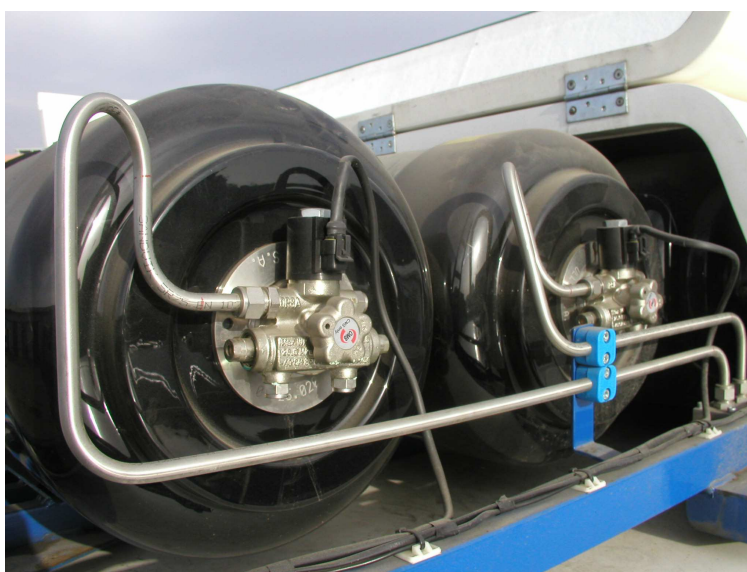
Obrázek 27: Komplexní ventily OMB umístěné na čelech tlakových nádrží
