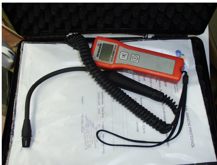
Obrázek 31: Ruční čidlo přítomnosti CNG 13
