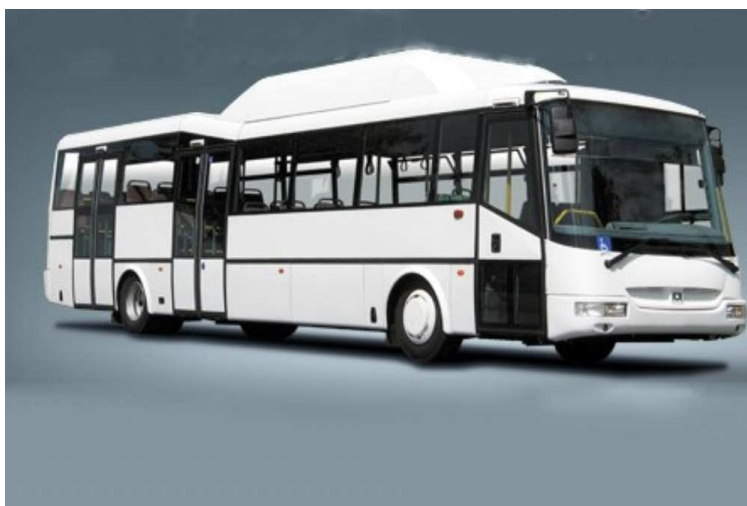
Obrázek 1: BNG 12. Délka 11,79 m, obsaditelnost 106 osob
