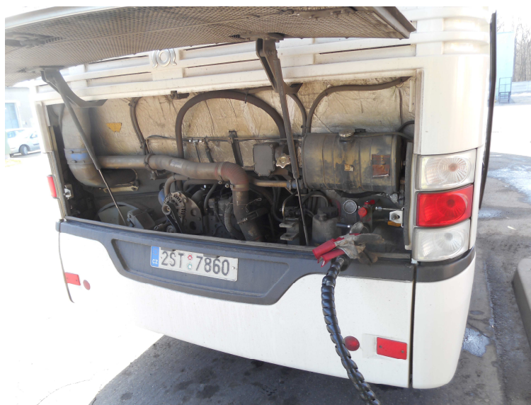
Obrázek 17: Plnění autobusu. Plnicí hlavice velkého průměru je zasunuta do soustavy vozu. Vůz má duální plnění, pod červenou plnicí hlavici v motorovém prostoru. Pod víčkem, které je nad ní, je plnicí otvor malého průměru
