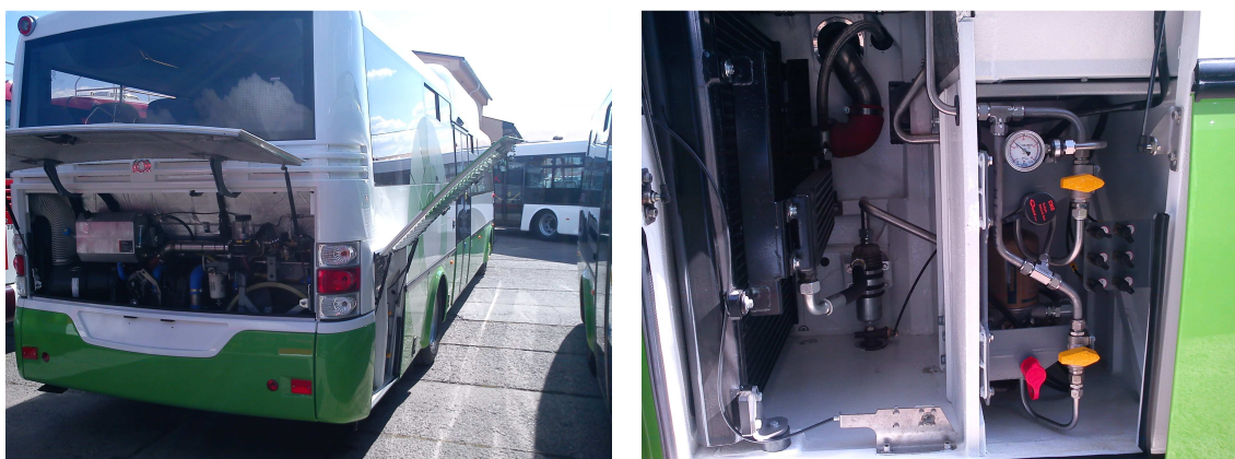
Obrázek 18: Plnění autobusu vyvedené do schránky v pravé boční části
