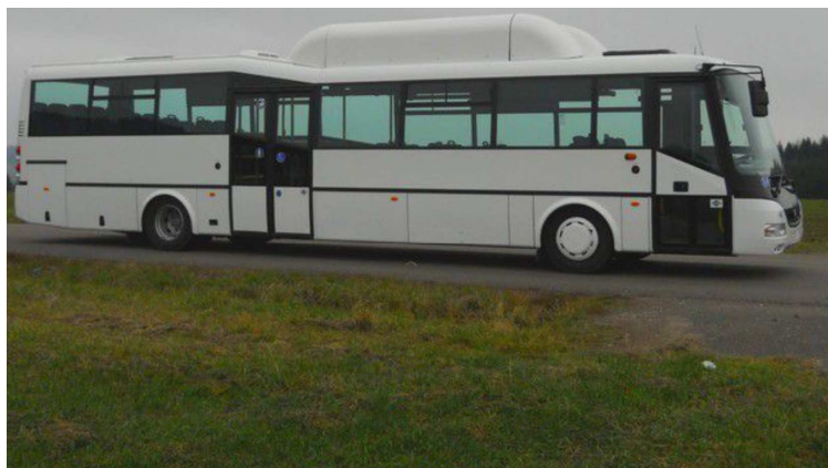
Obrázek 3: CNG 12. Délka 11,79 m, obsaditelnost 83 osob
