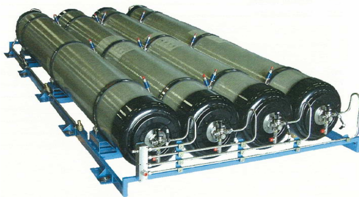
Obrázek 24: Nádrže CNG v silovém rámu, ve kterém jsou upevněny na střeše vozidla. Nádrže jsou v rámu upevněny samostatně a jako celek umístěný v rámu jsou upevněny na střeše autobusu
