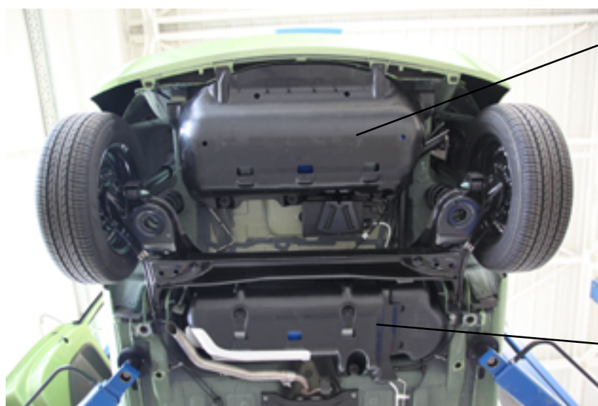
Obr. Tlakové nádoby na CNG s kryty pod podlahou zadní části vozidla.
