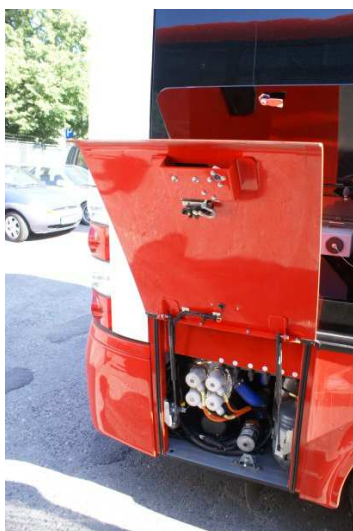
Obrázek 27: Umístění nezávislého naftového topení a elektrického bojleru u typů EBN
