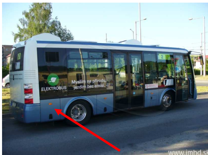
Obrázek 27: Umístění nezávislého naftového topení a elektrického bojleru u typů EBN
