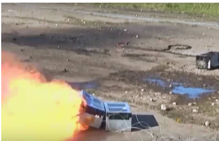
Obrázek 50: Začátek hoření - 10:45 po zahájení přebíjení
