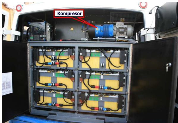
Obrázek 25: Kompresor v zadní části vozu
