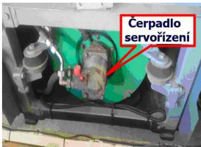
Obrázek 15: Detail umístění hlavního čerpadla servořízení
