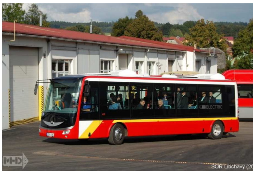
Obrázek 2: EBN 9,5: Délka 9,7 m; obsaditelnost 69+1 ( maximálně technicky přípustná hmotnost ) 16,5 t
