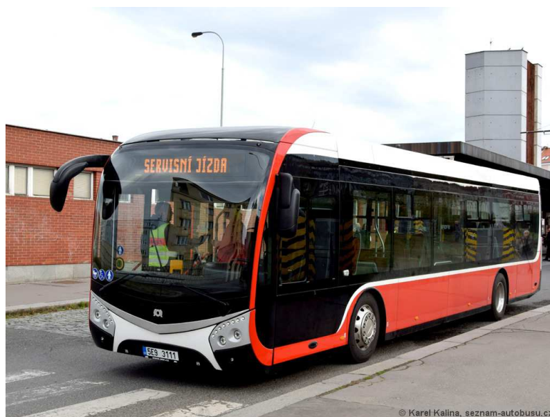
Obrázek 4: Autobus druhé generace ENS 12 s obsaditelností až 107+1 osob, maximálně technicky přípustná hmotnost 20 t
