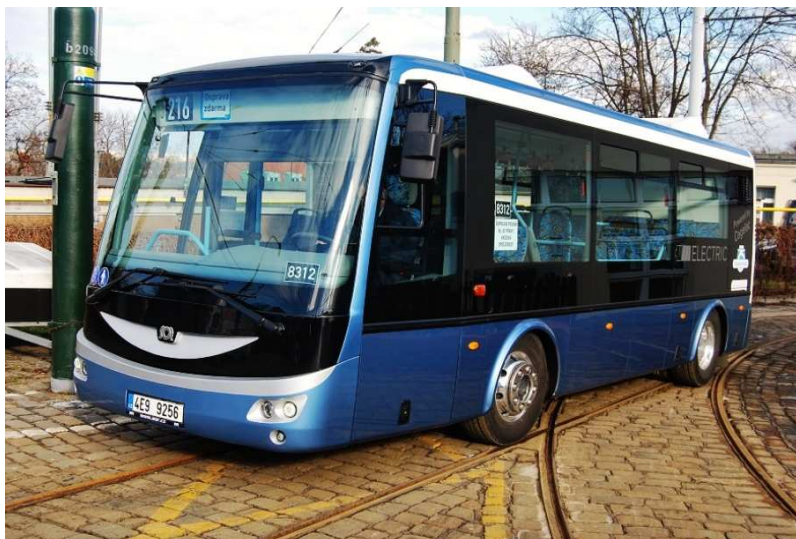
Obrázek 1: EBN 8: Délka 8,0 m; obsaditelnost 50+1, ( maximálně technicky přípustná hmotnost ) 16,5 t
