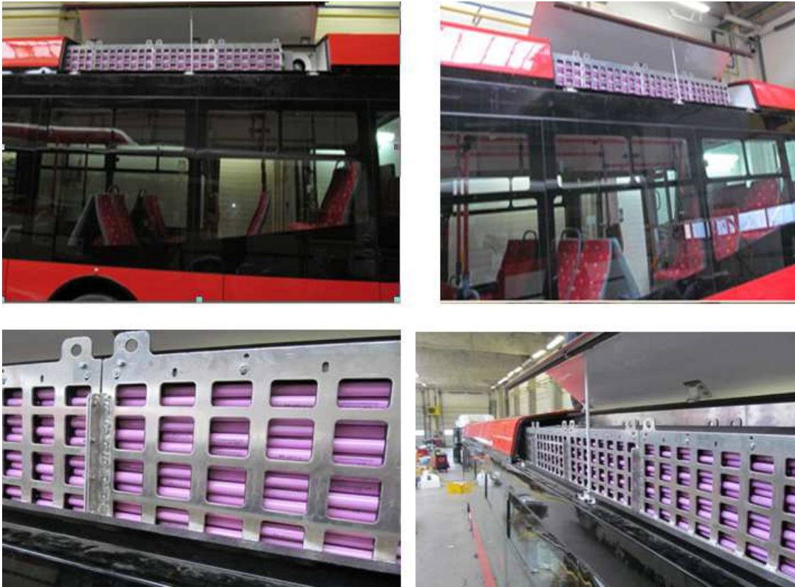
Obrázek 33: Umístění článků trakčního akumulátoru nad bočnicemi autobusu ENS
