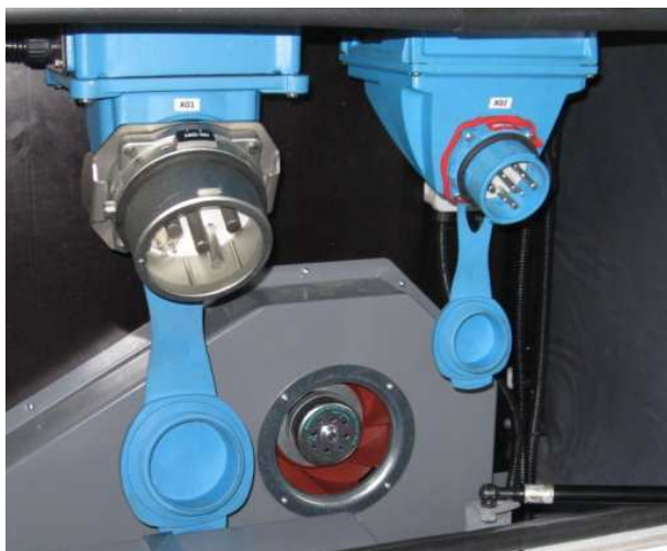
Obrázek 6: Nabíjecí zásuvky staršího provedení vozu první generace. vlevo - rychlonabíjení ( 200A ), vpravo – standartní nabíjení ( 32A )
