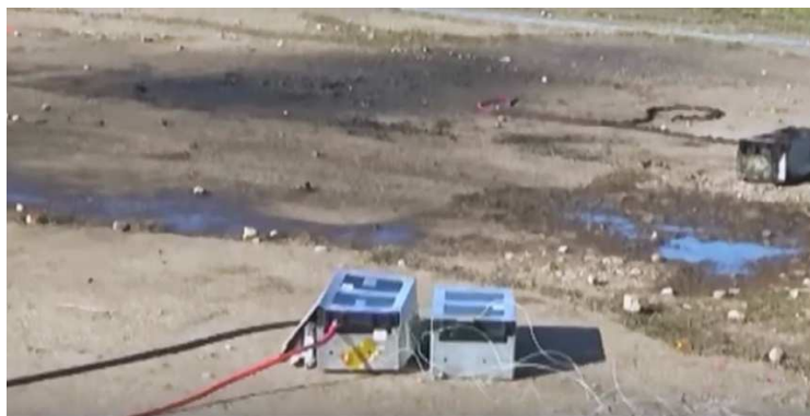
Obrázek 49: Porušení obalu článku - 9:02 po zahájení přebíjení 18
