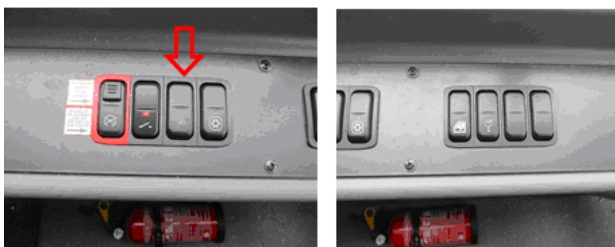
Obrázek 39: Levý podokenní panel přístrojové desky, kde je šipkou vyznačen spínač odpojící zastávkovou brzdu (symbol na ovladači je shodný s vozy řady EBN)
