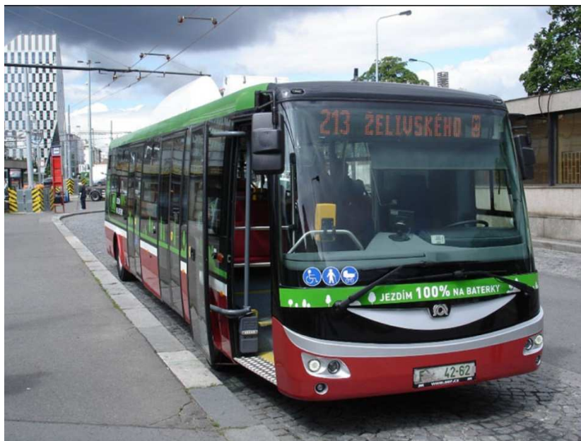
Obrázek 3: EBN 11: Délka 11,1 m; obsaditelnost 92+1 ( maximálně technicky přípustná hmotnost ) 16,5 t
