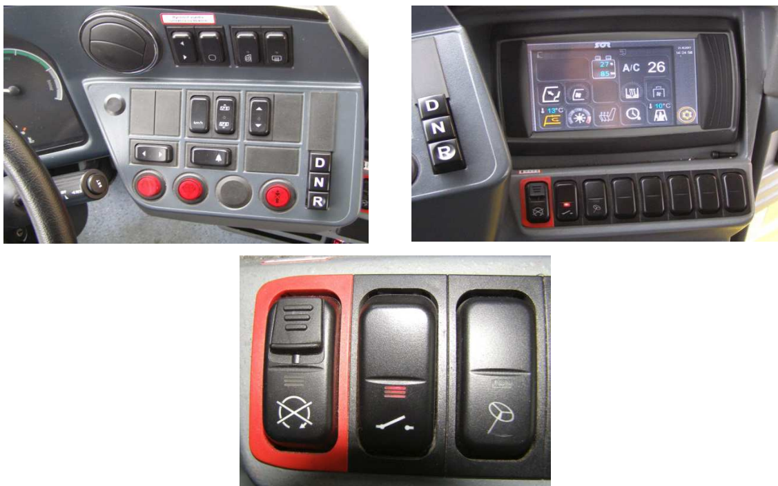
Obrázek 24: Umístění spínačů pod pomocným displejem. Kolébkové spínače odleva: nouzový odpojovač palubních akumulátorů, - provozní odpojovač - spínač vyřazení zastávkové brzdy z činnosti. Na levém horním snímku je sada přepínačů směru jízdy
