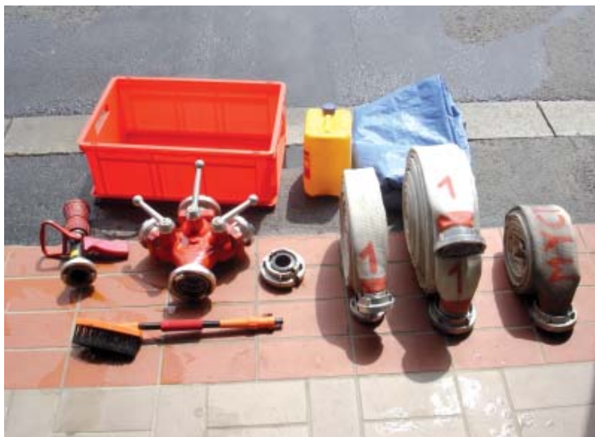
Obr. 48 Technické prostředky k vytvoření provizorního dekontaminačního stanoviště
