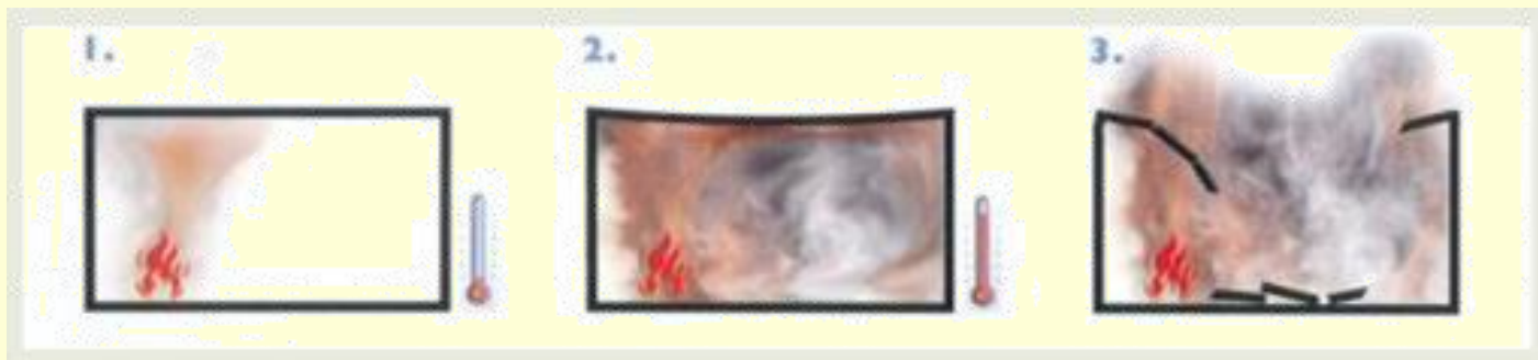
poškození stavby následkem požáru bez zařízení pro odvod tepla a kouře
