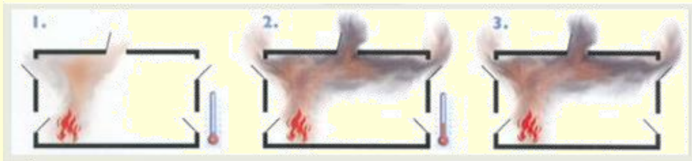
stavba při požáru se zařízením pro odvod tepla a kouře
