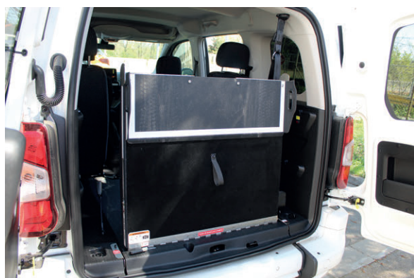
Obr. č. 9.28 Nájezdová rampa
