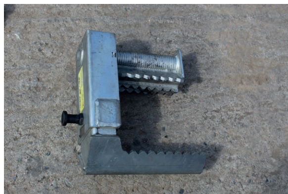
Obr. č. 15.58 Prahová opěrka
