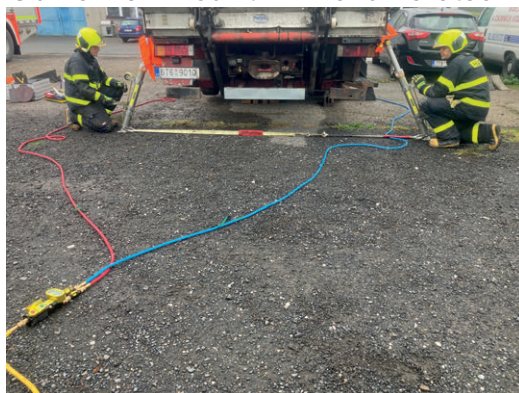
Obr. č. 20.6 Stabilizace pomocí tyčí
