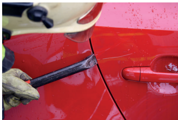
Obr. č. 15.34 Vytváření otvoru páčidlem
