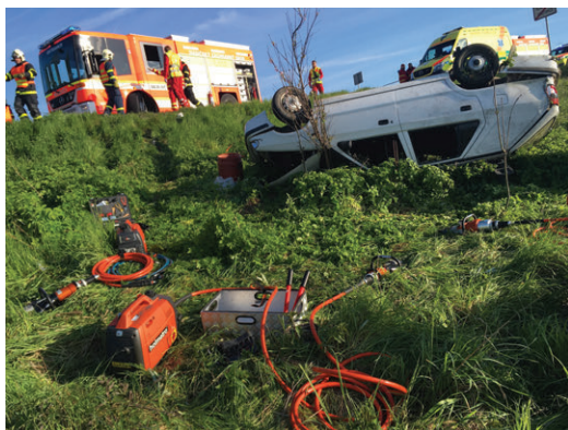
Obr. č. 3.1 Stabilizace OA ve svahu
