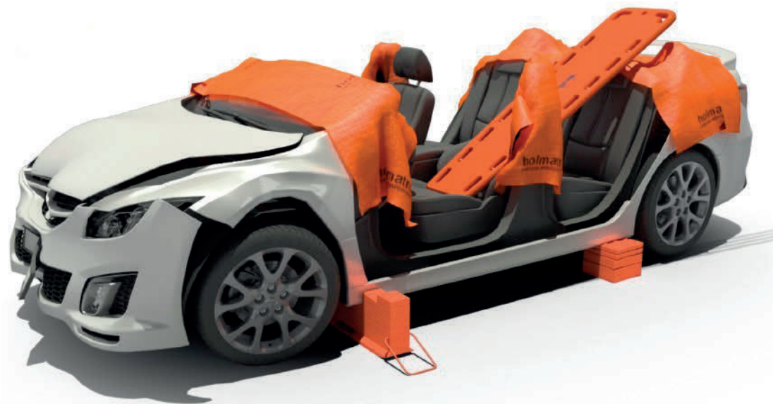
Obr. č. 21.2 Správně připravený vůz pro vyproštění
