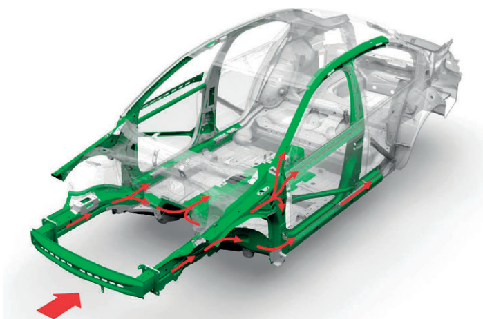
Obr. č. 8.13 Rozložení sil působících při čelním nárazu
