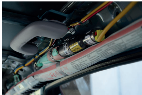
Obr. č. 8.23 Umístění pyropatrony ve střeše
