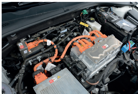
Obr. č. 8.33 HV elektroinstalace
