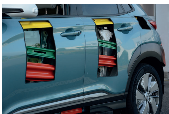
Obr. č. 8.28 Výztuhy ve dveřích
