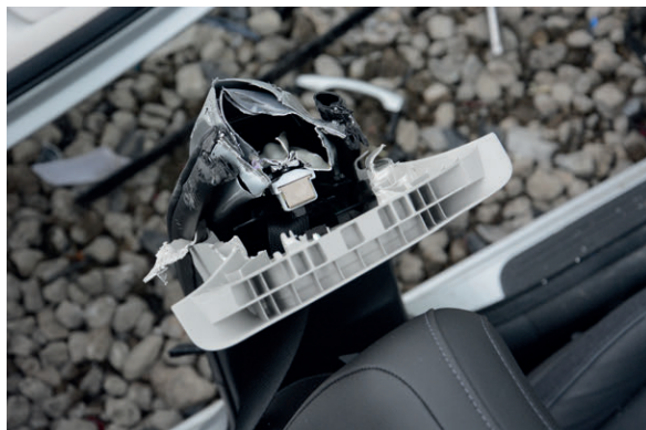
Obr. č. 8.10 B sloupek po přestřížení
