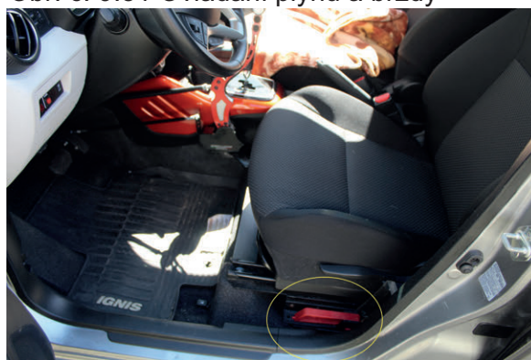
Obr. č. 9.33 Odjištění zadních dveří
