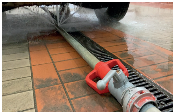
Obr. č. 24.16 Chlazení hloubkovou proudnicí
