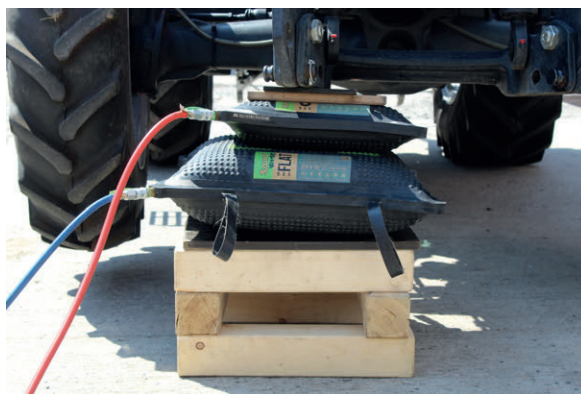
Obr. č. 20.10 Dofouknutí horního vaku
