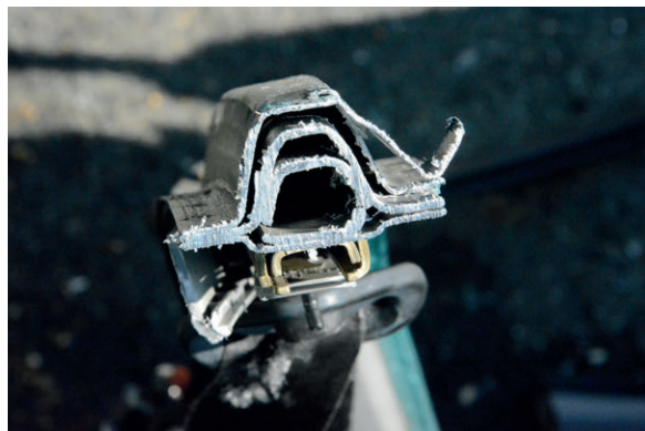
Obr. č. 8.11 B sloupek po přeřezání
