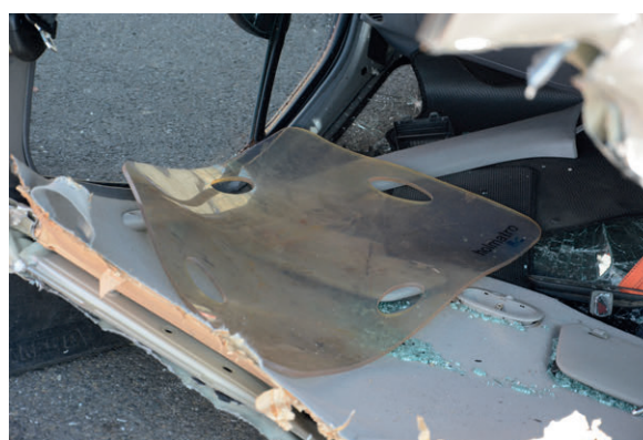
Obr. č. 15.48 Ochranný štít
