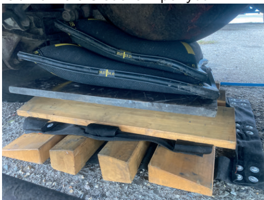
Obr. č. 20.5 Nevhodně vyskládané vaky
