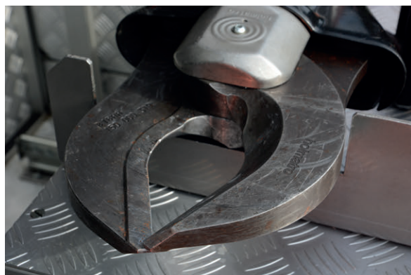
Obr. č. 15.9 Bezpečné uložení nůžek
