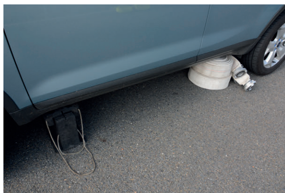
Obr. č. 18.15 Provizorní stabilizace
