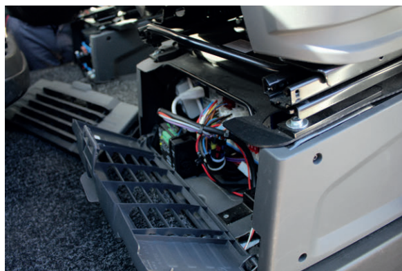
Obr. č. 9.35 Rozšířená elektroinstalace
