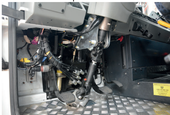
Obr. č. 9.13 Kloubové spoje na řízení
