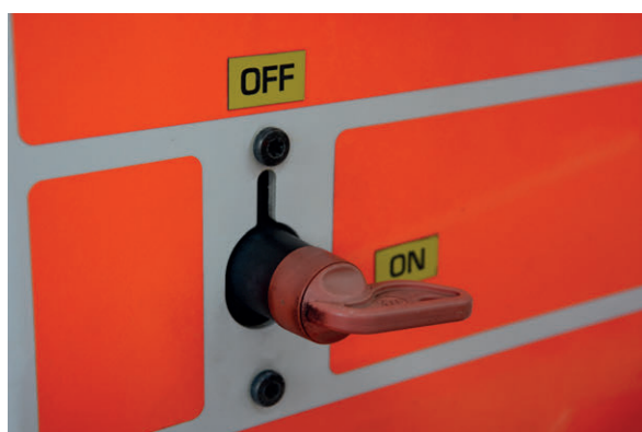
Obr. č. 9.6 Bateriový odpojovač viditelně
