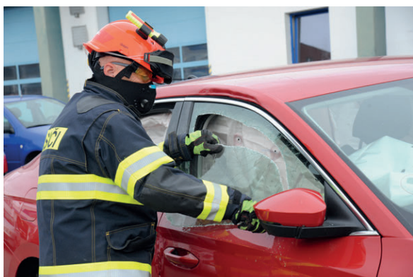
Obr. č. 8.4 Vrstvené bezpečnostní sklo
