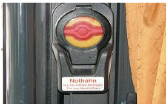
Obr. 66 umístění ventilů vnitřní strany
