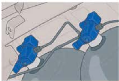
elektromagnetické uzavírací ventily na plynových nádržích
