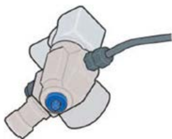
ruční uzavírací kohout po straně ventilu nádrže (do r. 2008).
