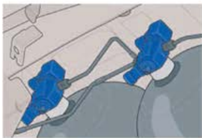
elektromagnetické uzavírací ventily na plynových nádržích
